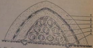
Kuva 49. Kaaliauma, jonka peittomullan välissä on eristävä oljikerros. 1 peittomulta, 2 oljikerros, 3 kaaleja, 4 oja.
