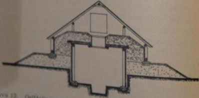
Kuva 13. Osittain maan sisään kaivetun kuopan poikkileikkauspiirros.
