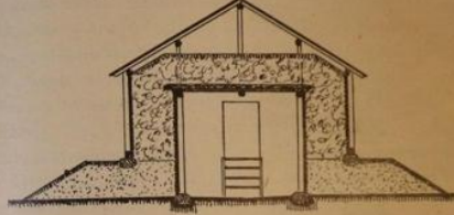
Kuva 14. Kokonaan maan päälle rakennetun säiliön poikkileikkauspiirros.
