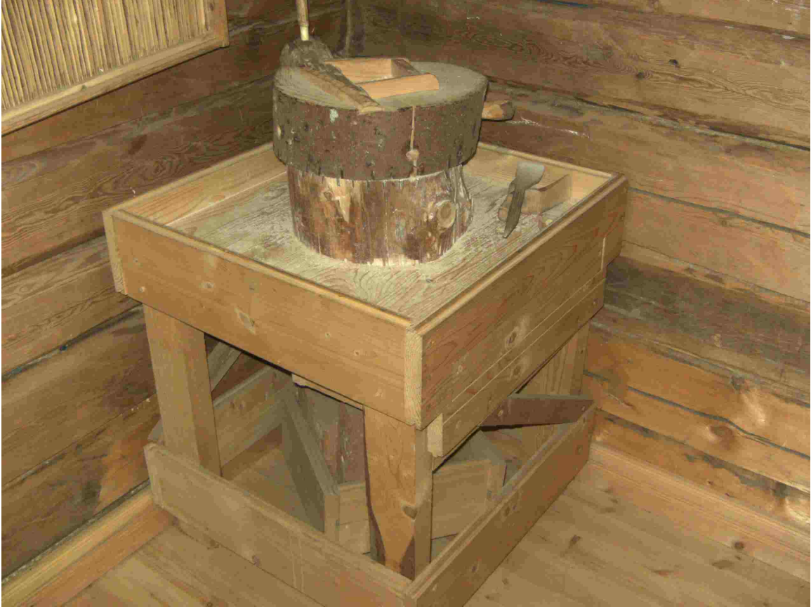
Nurkkaan sijoitettu mylly ei vaella jauhamisen aikana
