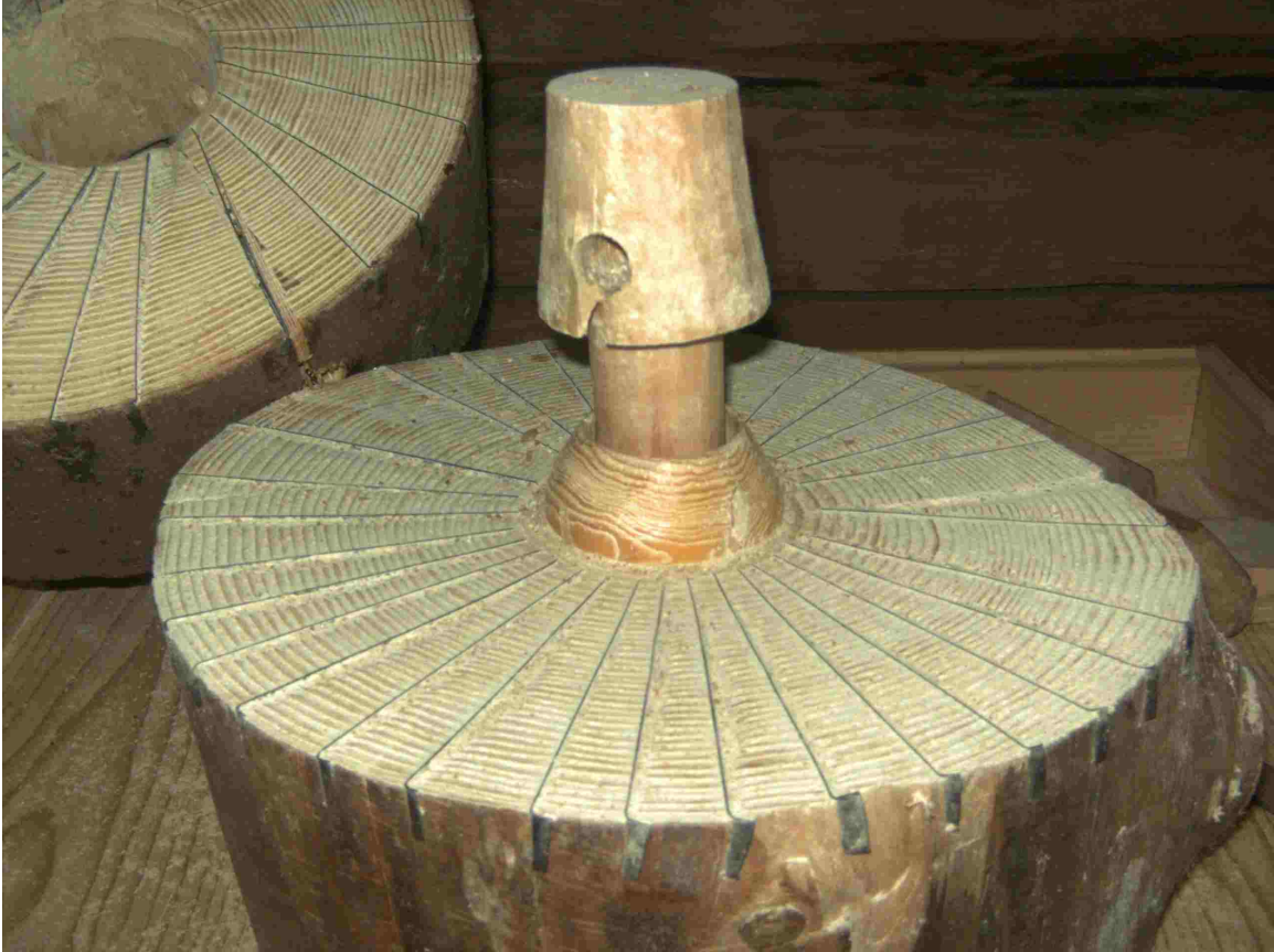
Alakiven kohouma ja akselin yläpää ohjaavat jyviä
